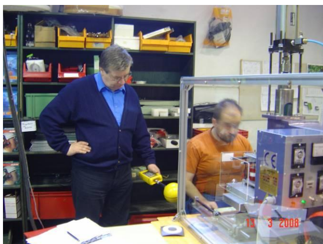
Kuva 9. Muovisaumaimen magneettikentän mittausta työntekijän kohdalta (kuva Arimo Ristola)
